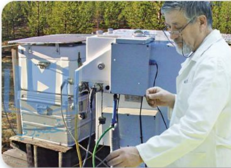
الشكل 1-4 يستعمل العلماء أنواعاً مختلفة من الأجهزة، ومنها مطياف بريور لقياس كمية غاز الأوزون في الجو.
